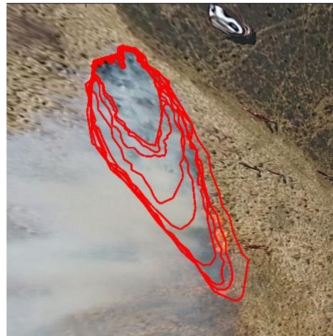
Fotogrametricky upravené snímky a manuálna segmentácia hranice požiaru
