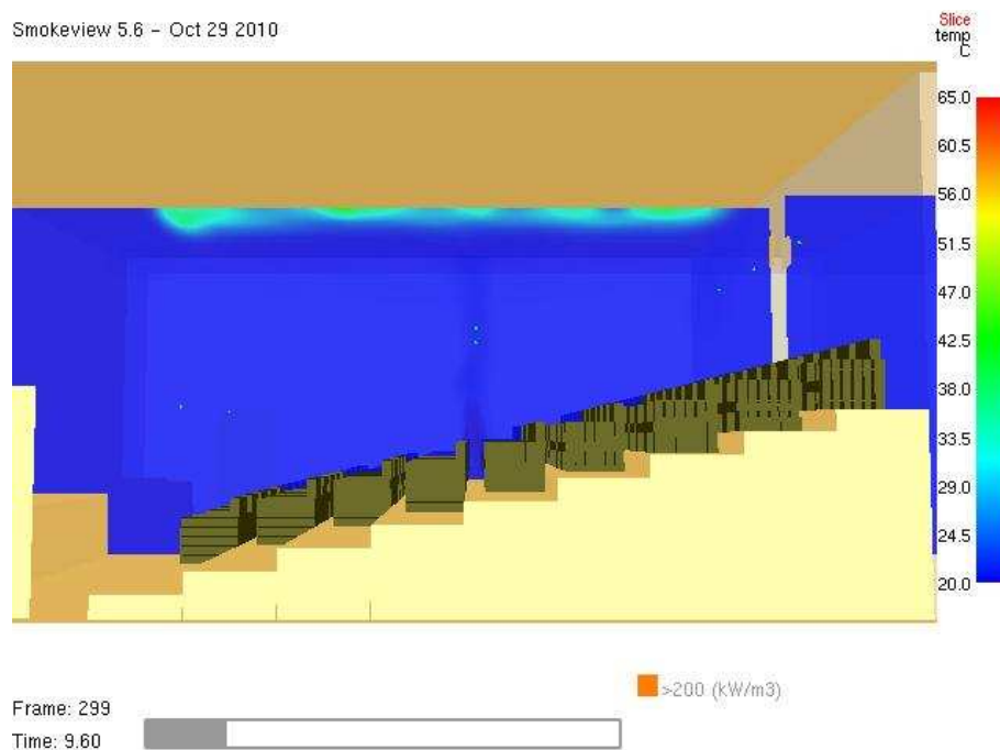
Obr. 77 Teplotný rez pre simuláciu v čase 9.6 s (pohľad z boku)
