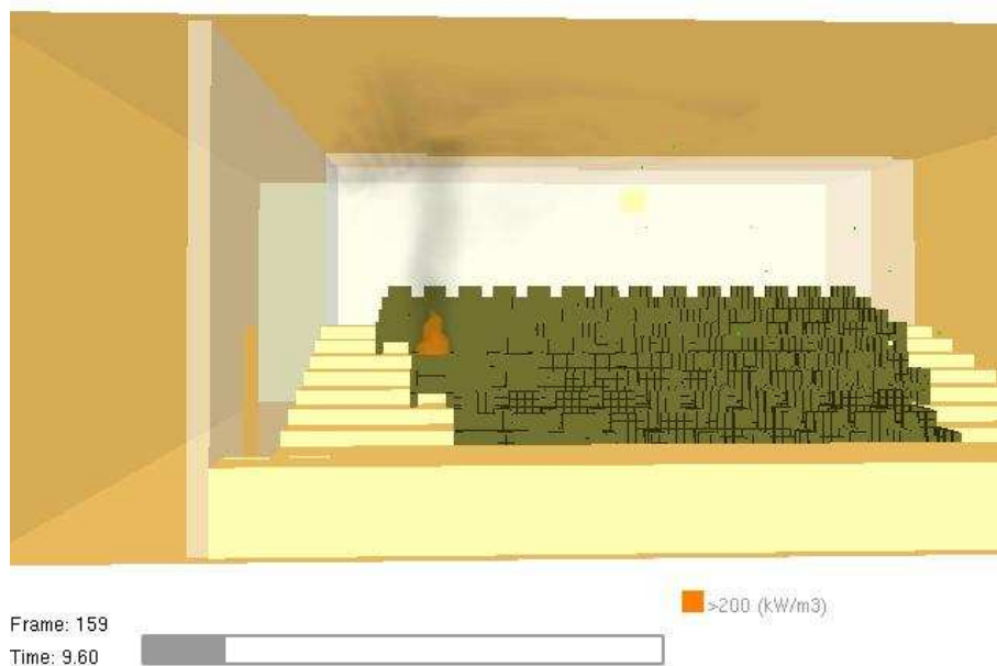
Obr. 76 Simulácia šírenia požiaru a dymu v 9.6-tej sekunde (pohľad spredu)
