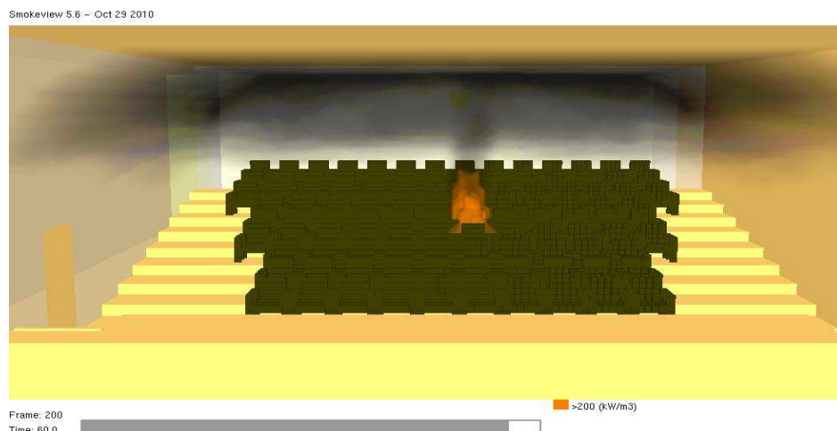
Obr. 70 Simulácia šírenia požiaru a dymu v 60-tej sekunde (pohľad spredu)
