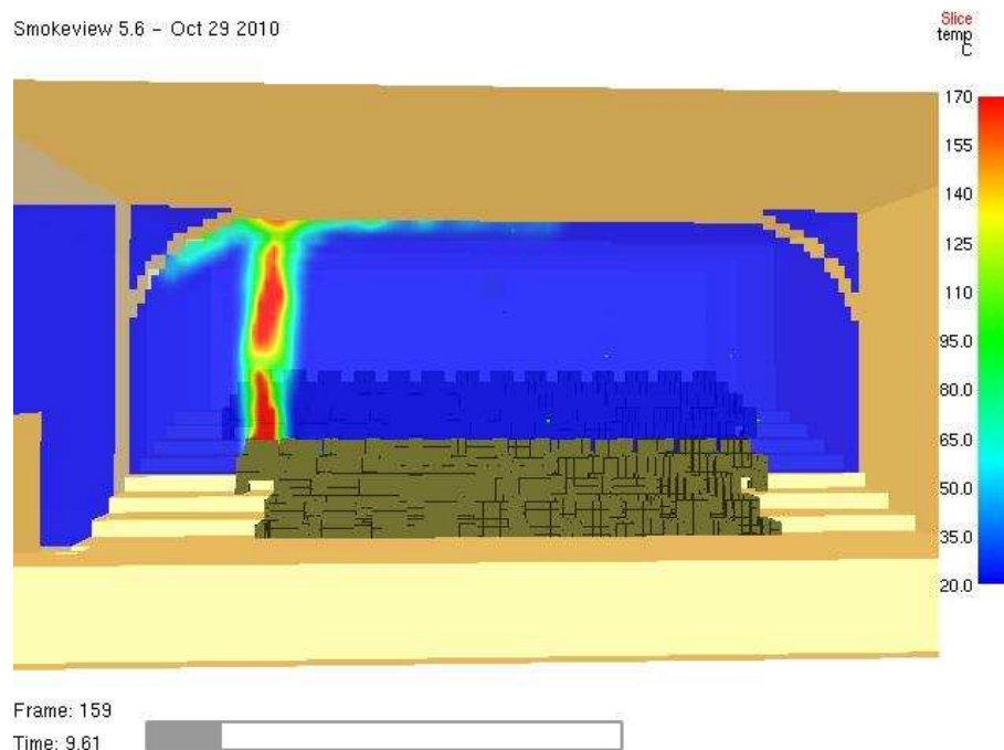
Obr. 78 Teplotný rez pre simuláciu v čase 9.6 s (pohľad spredu)
