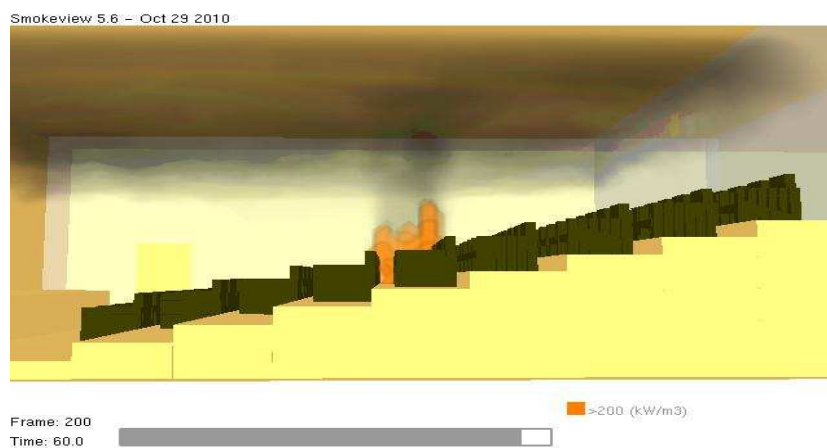
Obr. 69 Simulácia šírenia požiaru a dymu v 60-tej sekunde (pohľad z boku)
