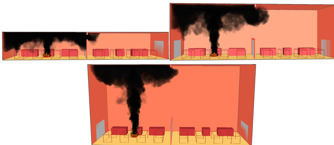
Obr. 30 Simulácia požiaru v hale 1 (hore vľavo), v hale 2 (hore vpravo) a v hale 3 (dole) s posunutým zdrojom požiaru v čase 8 s.
