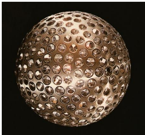
Obr. 7: Družica LAGEOS, ktorá sa využíva pri meraní pomocou SLR
