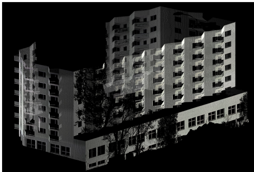
Obr. 4.2. Inžinierska geodézia – skenovanie fasády bytového domu – spracovanie mračna bodov.
