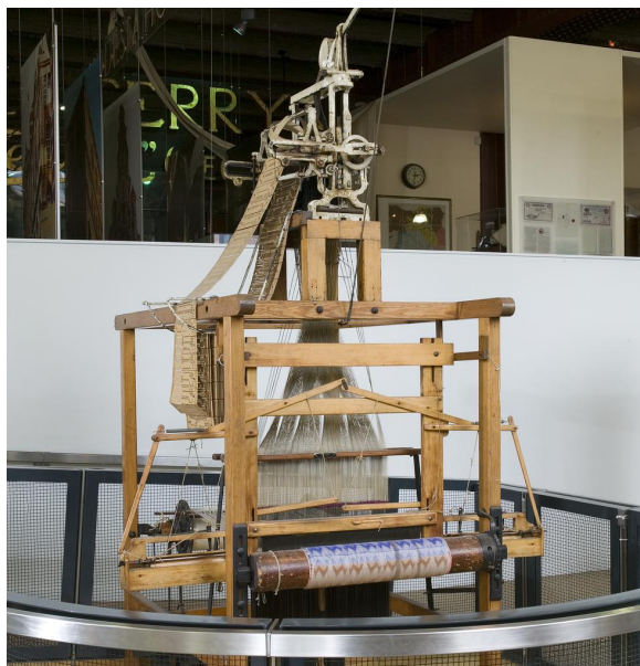
Obr. 1.3. Tkáčsky stroj navrhnutý vynálezcom Josephom Marie Jacquardom v roku 1801. Na ľavej strane je možné vidieť dierkované karty, v pozadí nite a v popredí valec s navinutou utkanou látkou. Zdroj: Museum of Science and Industry in Manchester .
